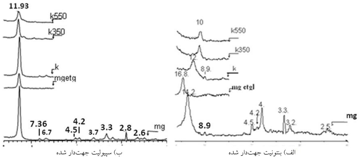
شکل ۲. دیفرکتوگرام اشعه ایکس نمونه‌های جهت‌دار شده بنتونیت (الف) و سیپولیت (ب)
