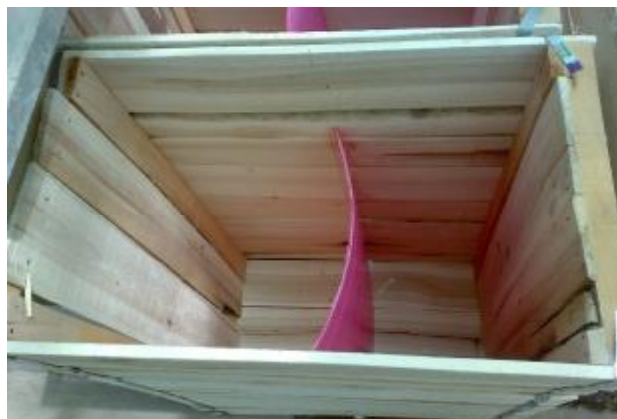
شکل ۱. جعبه چوبی و تیغه وسط آن برای آزمایش PRD
