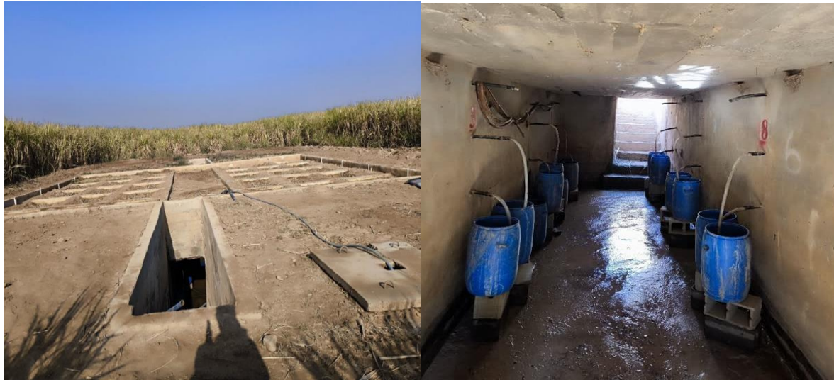
شکل ۱. تصویر لایسیمترهای حجمی بتنی مورد استفاده در آزمایش Fig. 1. Image of the concrete volumetric lysimeters used in the experiment
